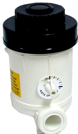
O cloro é adicionado na dosagem desejada pela sucção da água que passa pelo interior do aparelho (sistema Venturi), sendo a vazão ajustada por uma válvula reguladora de fluxo. Por não ser elétrico, dispensa a ligação em paralelo com bombas de recalque ou a instalação de válvulas de fluxo como a das bombas dosadoras eletrônicas.
