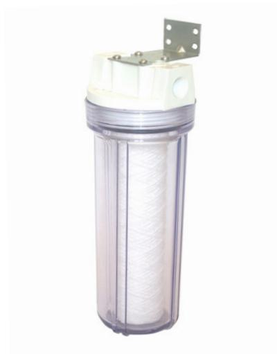
A manutenção do filtro pode ser feita pelo próprio usuário, pois é extremamente simples e só requer uma chave para abertura da carcaça (também fornecida com o filtro), remoção do cartucho entupido, lavagem do copo da carcaça e colocação de um cartucho novo.
